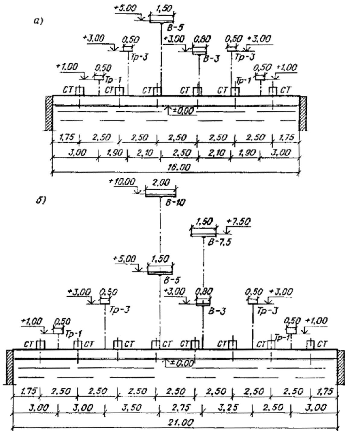
Рис. 4. Схемы расстановки устройств для прыжков в воду и стартовых тумбочек в универсальных ваннах (размеры в м)
