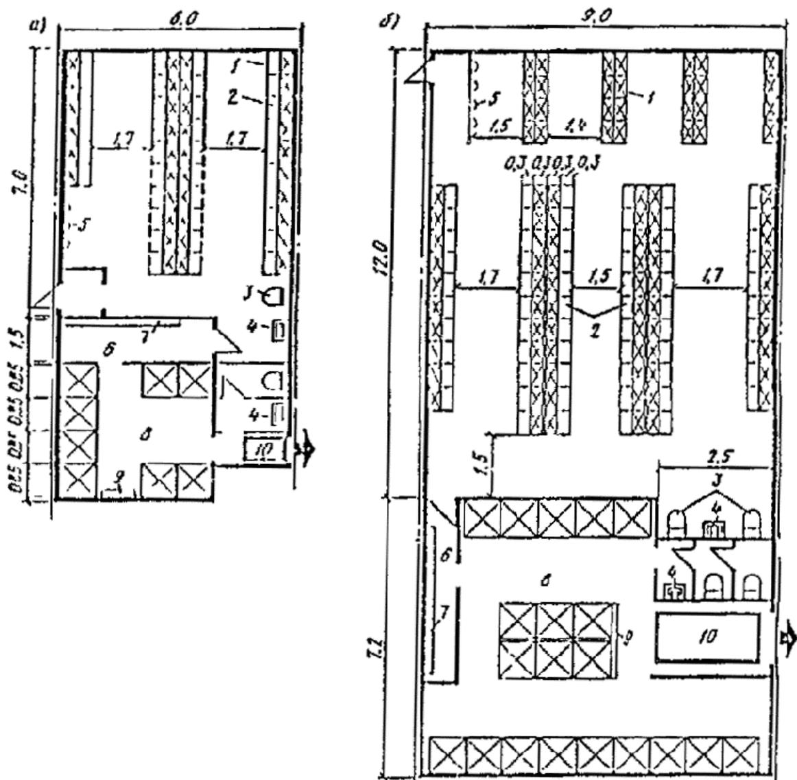
Рис. 16. Схематический план блока раздевалки с душевой и санузелом
